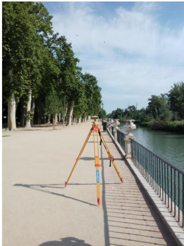
*Imagen 2.- Receptor GNSS de doble frecuencia estacionado en la base principal (BASE-AR3) del levantamiento de datos de los puntos de control terrestre, registrando datos de código y fase de las constelaciones GPS y GLONASS.*
