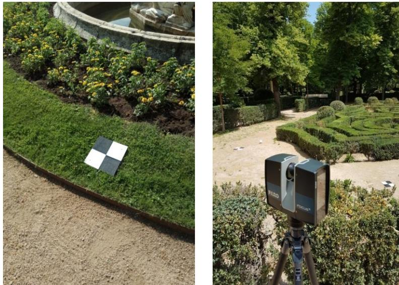
**Imagen 1.-** a) marca de pre señalización a la espera de registrar su imagen mediante los diferentes sensores y a la espera de registrar sus coordenadas mediante técnicas GNSS; b) registro de imagen con laser escáner terrestre conjuntamente con las marcas de pre señalización. Desde estas últimas se le transferirá el sistema de referencia a los datos registrados en el escáner terrestre.
