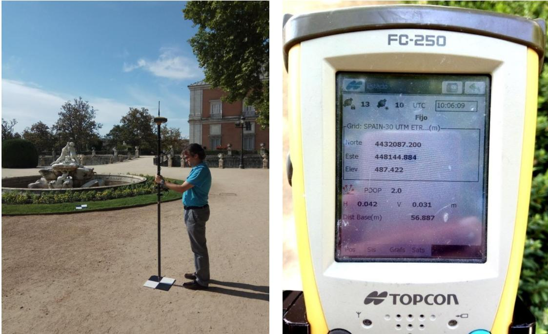
**Imagen 3.-** a) toma de datos con receptor GNSS autónomo de los puntos de control terrestre mediante el método 'RTK'; b) registro de coordenadas horizontales (este y norte) y vertical (elevación) mediante el método 'RTK'.
